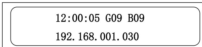
LED 显示屏分为上下两排显示，第一排显示时间、GPS 卫星、北斗卫星信息。第二排在服务器 IP 地址信息与日期、时间来源、捕获状态之间切换。
