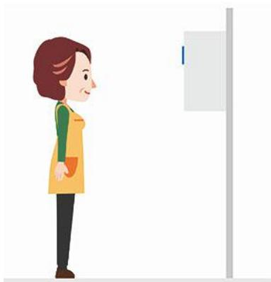
1、使用者面对机器屏幕1米左右时，机器自动开始读取面部体征，屏幕下方提示“请靠近摄像头”；距离缩短到0.7米左右时取纸机开始自动识别。
