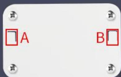
先使用自攻丝将底板的四角固定在墙壁上
